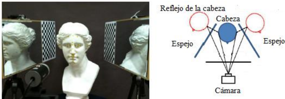
Figura 2.8. Escenario de adquisición de la imagen del método de Hwang et al. [29]
