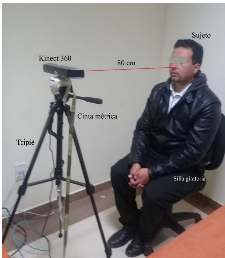
Figura 3.3. Escenario de adquisición de datos del sensor Kinect para Xbox 360 ©.
